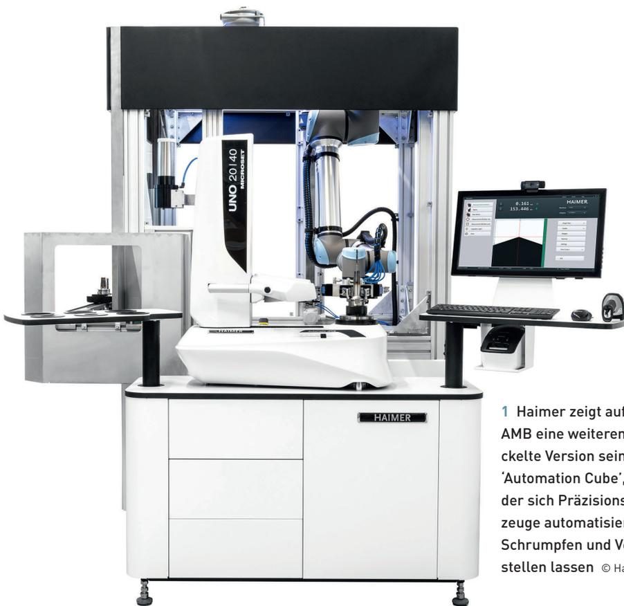
1 Haimer zeigt auf der AMB eine weiterentwickelte Version seines 'Automation Cube', mit der sich Präzisionswerkzeuge automatisiert schrumpfen und Voreinstellen lassen © Haimer
